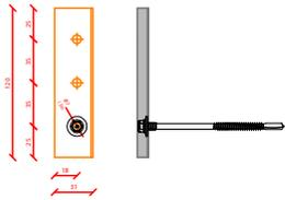
Lastverteilerplatte Alpha-AR FX
