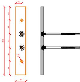
Lastverteilerplatte Alpha-AR FX
